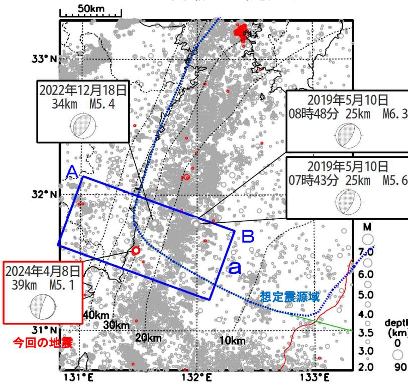
2024年4月8日10時25分に大隅半島東方沖の深さ39kmでM5.1の地震(最大震度5弱)が発生した。この地震はフィリピン海プレート内部で発生した。発震機構は西北西-東南東方向に張力軸を持つ正断層型である。
