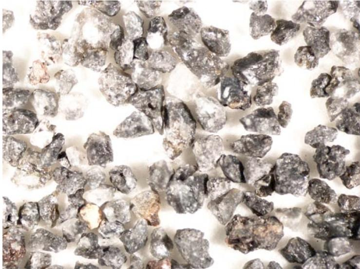
図1 洗浄後の直径1mm以上の粒子. 横幅 20 mm.
