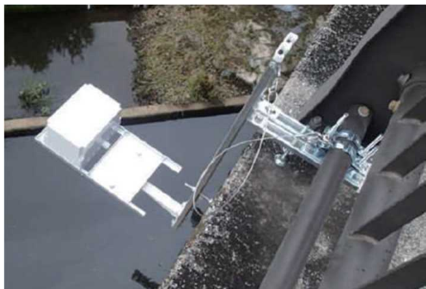
危機管理型水位計 (危機管理型水位計に関するポータルサイトより転載)
