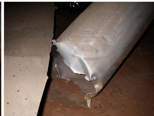
破断したフロートチューブ2
