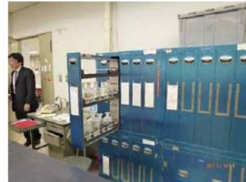
20階 薬品入れの引き出しが 飛び出し
