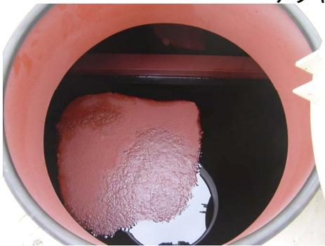
ポンツーン内への原油の滞油(3室で破損有)
