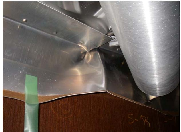
アルミ製内部浮き蓋の破損
