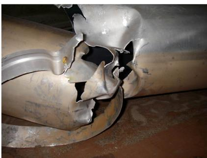
破断したフロートチューブ1
