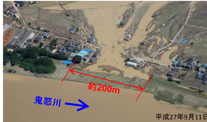
平成27年9月10日 12時50分 堤防決壊 決壊幅約200m
