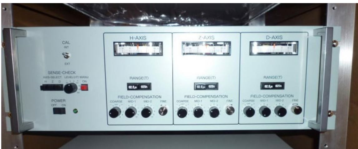
図 7-4-13 フラックスゲート磁力計（1993年～） 検出器（上）と増幅器（下）
