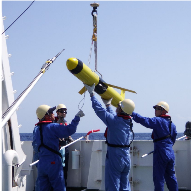
図 7-2-36 水中グライダーの海中への投入作業 (平成28年5月北太平洋上の凌風丸にて)
