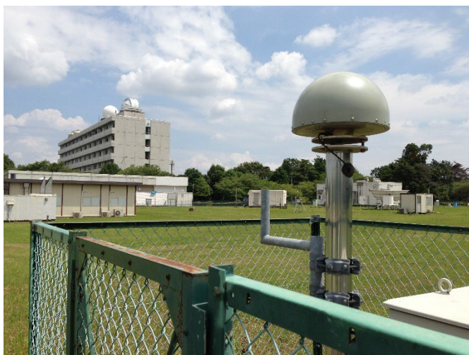
図 7-2-15 受信アンテナ（平成25年8月） 受信アンテナは灰色の半球ドームに覆われている
