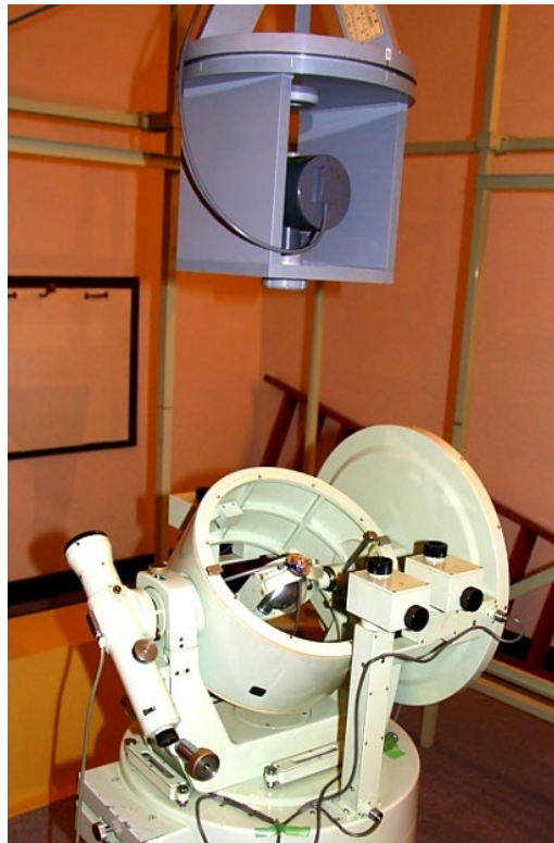
図 7-4-25 プロトン磁力計PM-216（F成分）（写真上）（2012年～）
