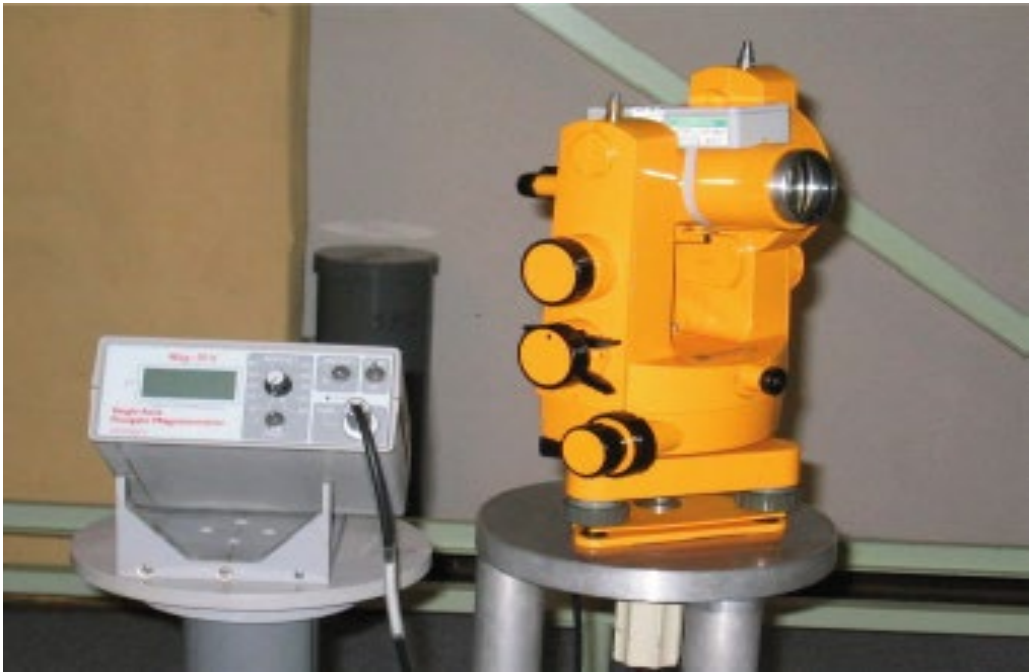
図 7-4-24 M0-P型ベクトルプロトン磁力計（F、H、Z成分）（1963年～）
