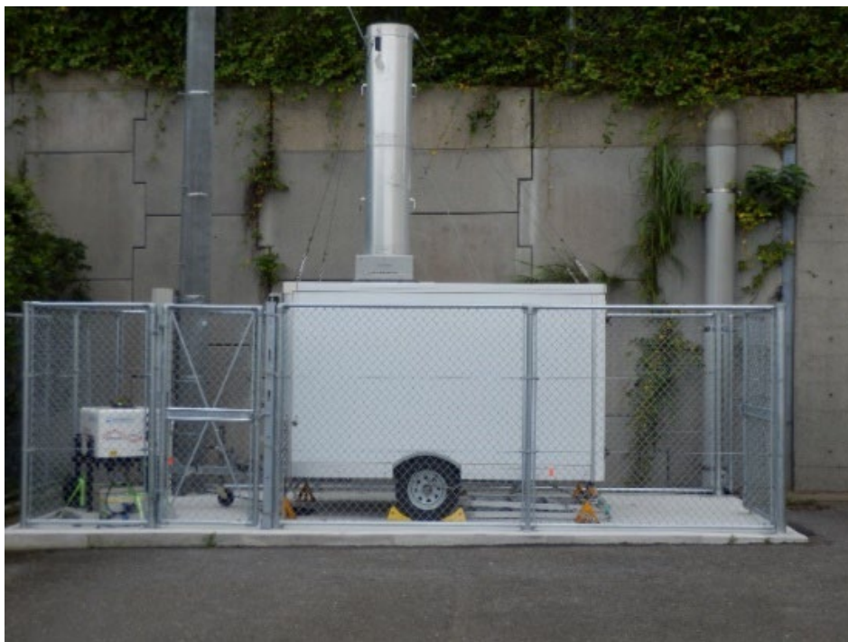
図 7-2-24 機動観測用水蒸気ラマンライダー
