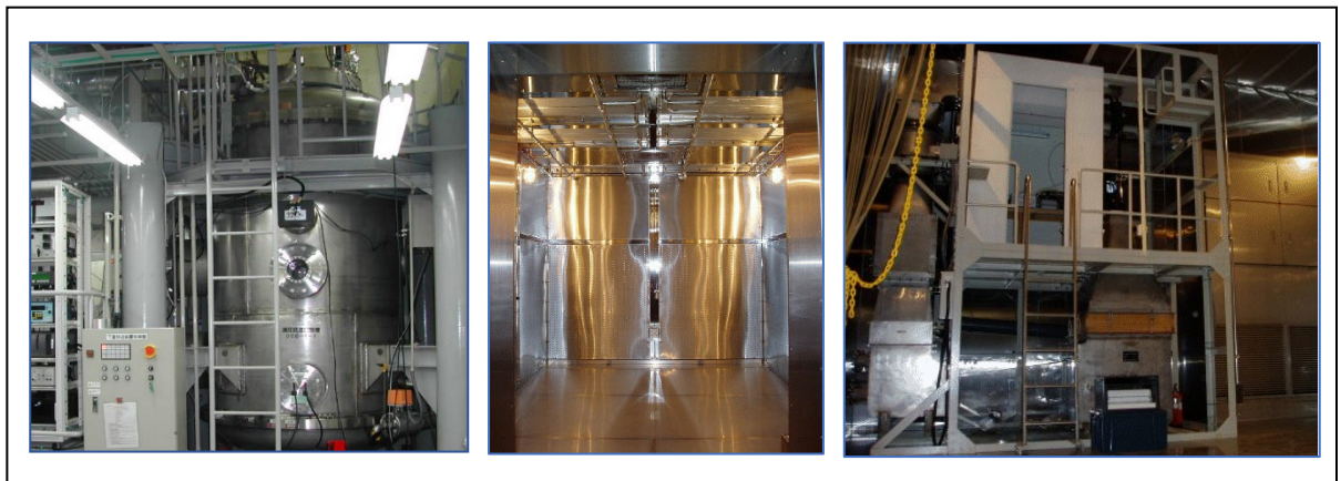
図 7-2-5 ・平成16年改修後の減圧低温試験槽（雲生成チェンバー）（左） ・ -90^{\circ}\text{C} 低温実験室（中央） ・ -40^{\circ}\text{C} 低温実験室（右）
