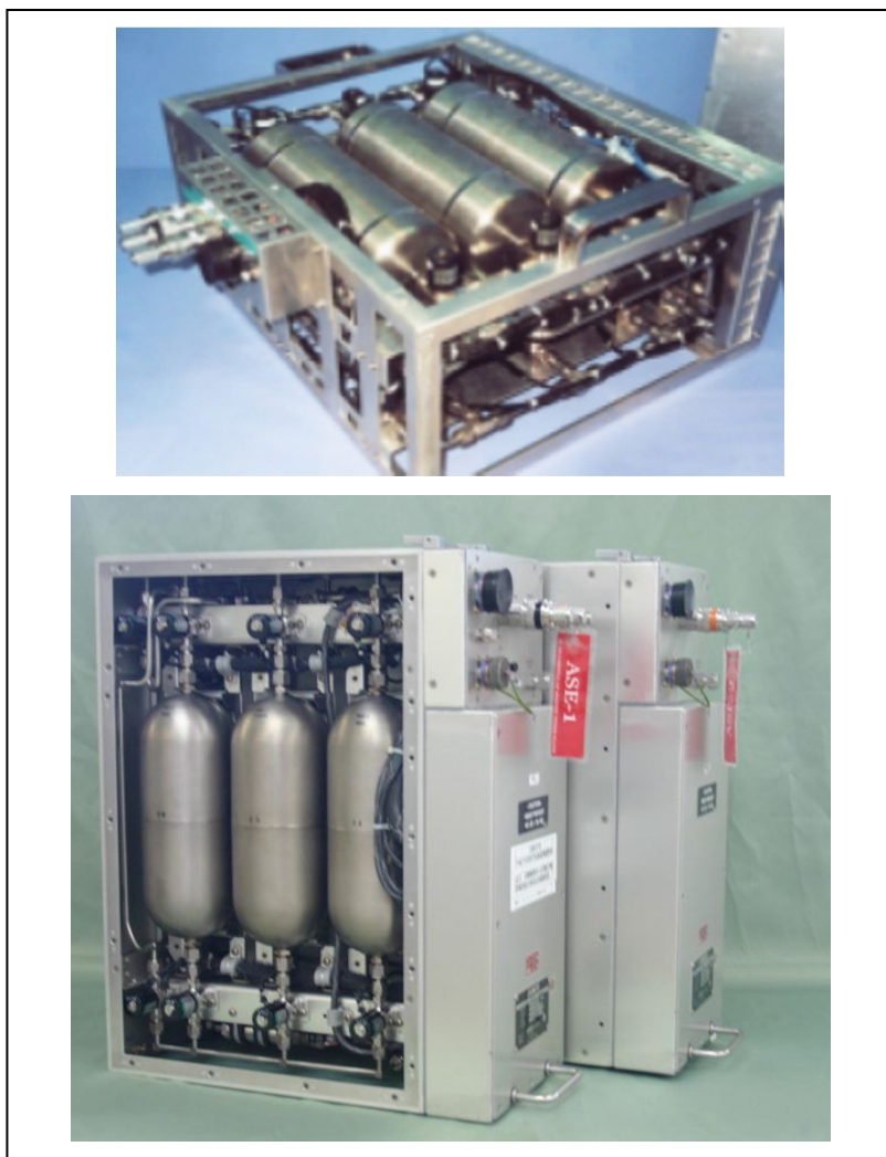
図 7-2-35 同プログラムで開発し、日航機の貨物室に搭載して使用してきた ・自動大気採取装置 1号機（平成5年製作）（上） ・2号機（平成17年製作）（下）
