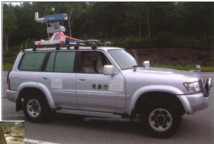
車両にセンサーを設置
