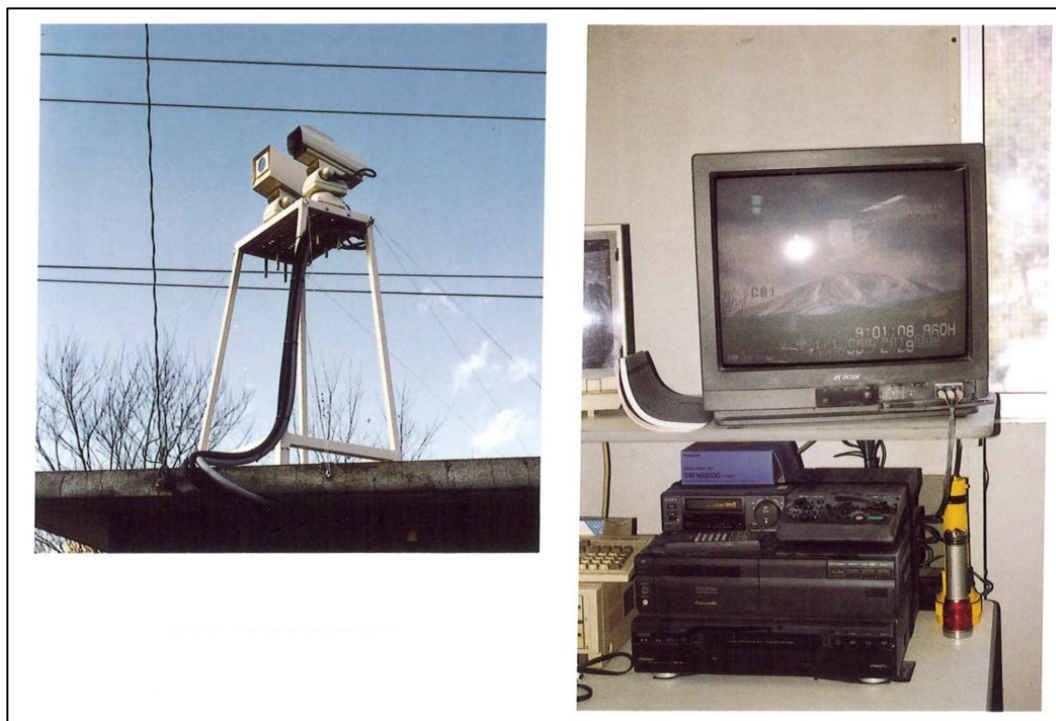
図 6-2-1 遠望観測装置と画像受信装置（1980年代～1990年代）
