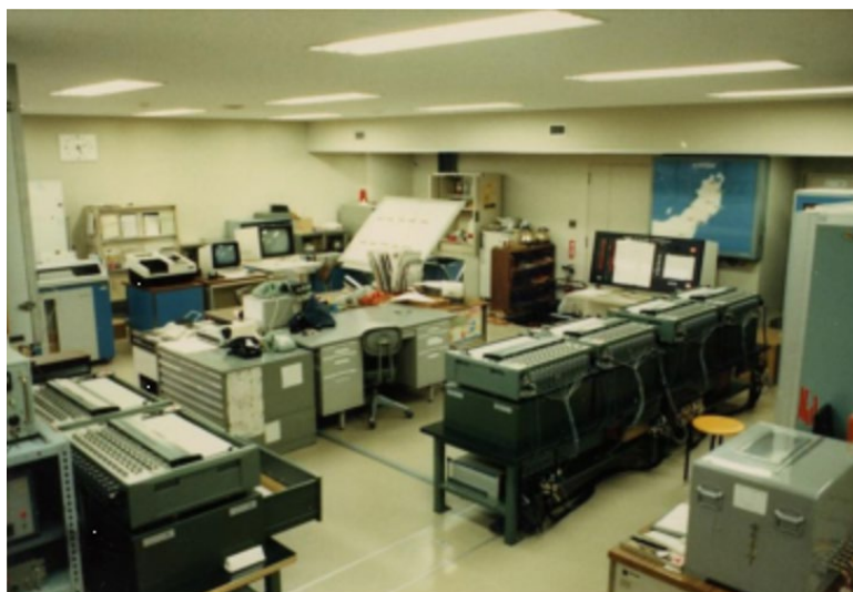
図 6-3-1 L-ADESS端末を用いた震源計算・津波判定を行う装置
