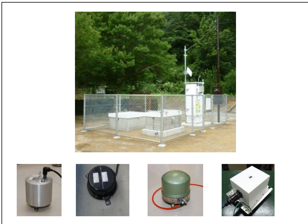
図 6-1-1 多機能型地震観測装置（検知網型）と 速度型地震計、加速度型地震計、広帯域地震計、広帯域強震計
