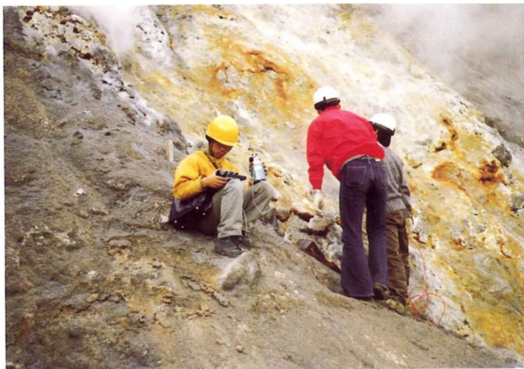
熱電対温度計による温度観測(有珠山、1977年)
