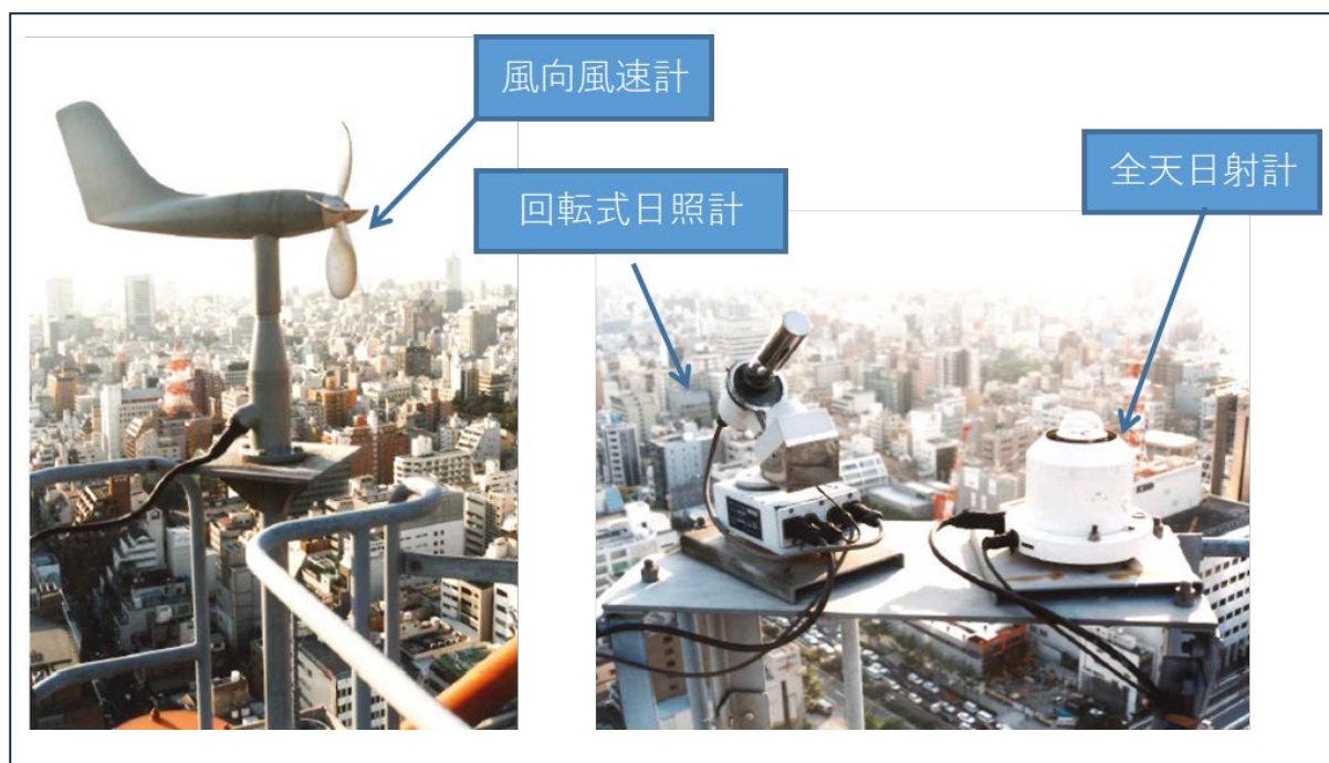
図 5-5-1 大阪合同庁舎第2号館屋上（測風塔）に設置した風向風速計、回転式日照計、全天日射計
