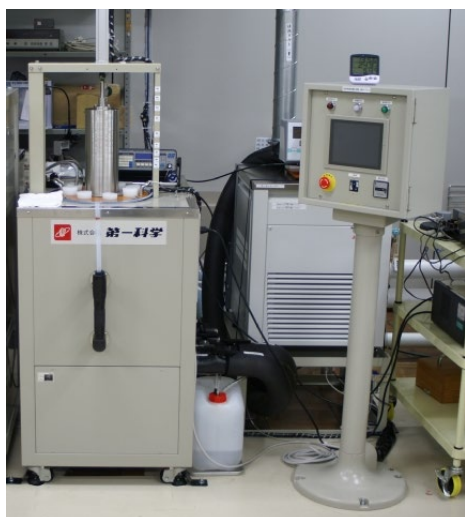
図 5-5-15 温度計検査装置（液槽）
