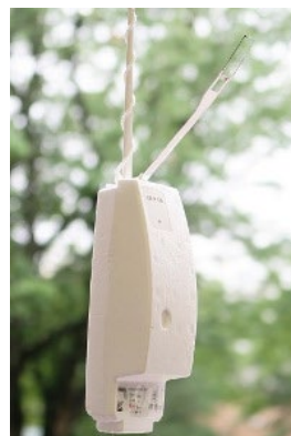
図 5-5-48 RS41-SG型 GPSゾンデ
