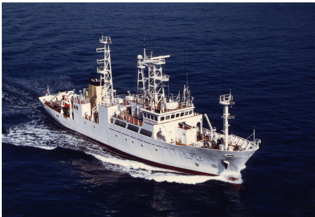
図 5-6-23 長風丸（Ⅱ世） 昭和62年建造。総トン数 480トン。長崎海洋気象台所属新しい世代の中型観測船として、当初からCTD観測や高層気象観測などが効率よく実施できるよう設計・建造された。高風丸（Ⅱ世）、清風丸（Ⅲ世）は準同型船。近年の主な気象庁観測船とは異なり、マストと煙突が一体となったマック形式を採用していないのが外観上の特徴。
