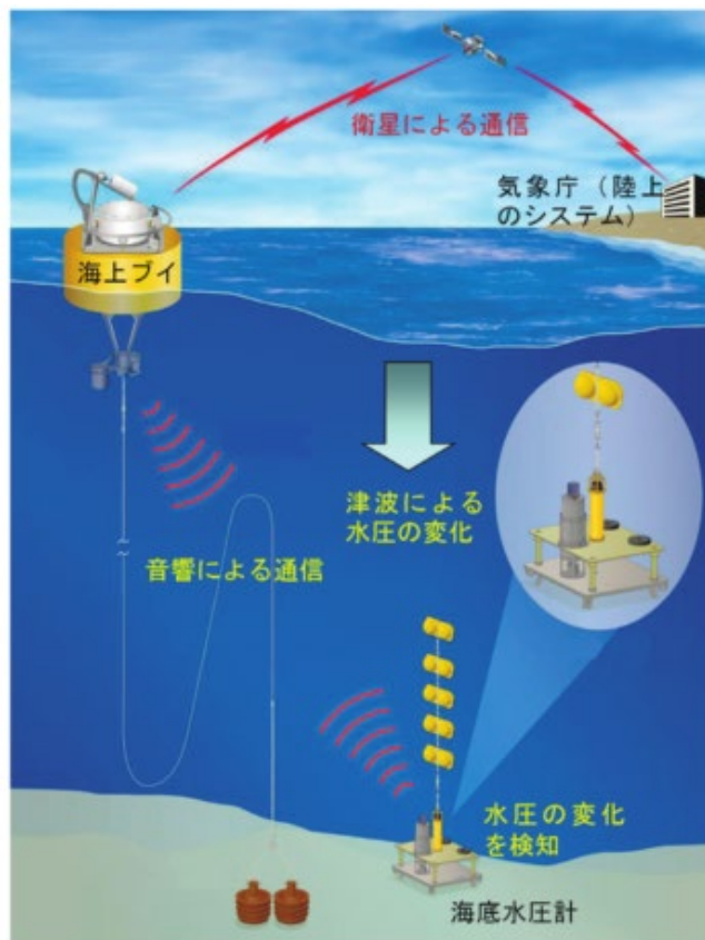
図 5-6-8 ブイ式海底津波計の海上設置作業（上）と観測システム概要（下） 東北地方太平洋沖の日本海溝東側に3基のブイ式海底津波計を整備。日本海溝付近で発生する津波を、既存の観測網に比べて場所によっては10分程度早く捉えることが可能。2012年12月から2016年8月までの期間、津波監視に活用された。
