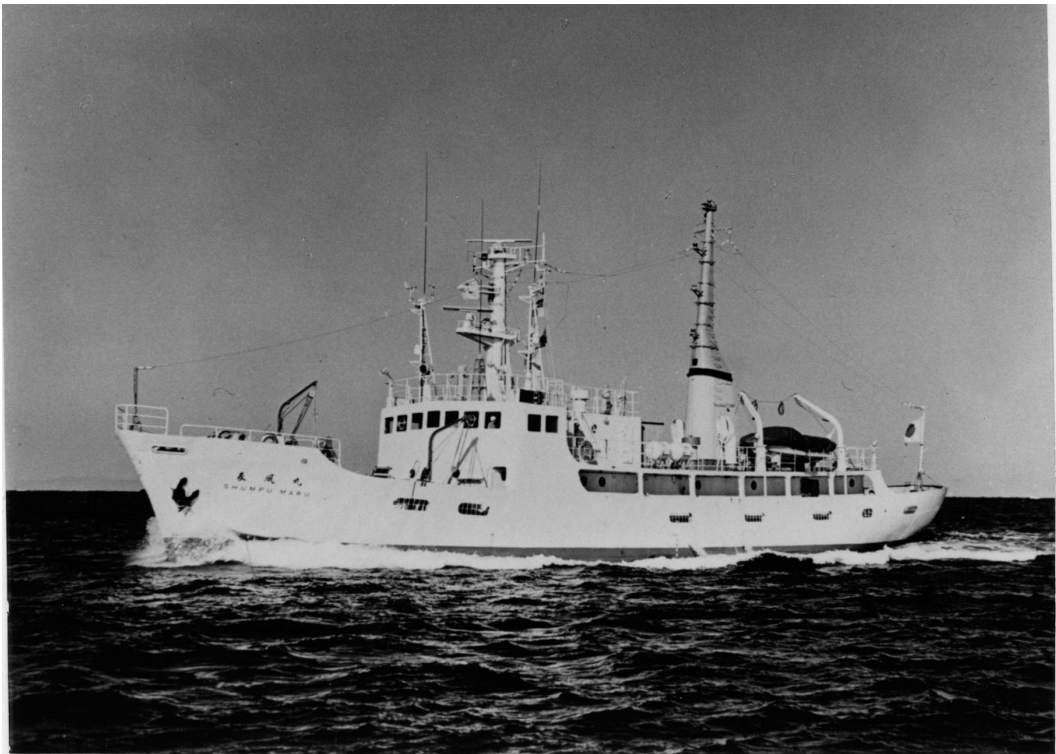
図 5-6-21 春風丸（Ⅲ世） 昭和49年建造。総トン数 373トン。神戸海洋気象台所属。他の海洋気象台に新しい世代の中型観測船（長風丸（Ⅱ世）など）が配備されるのと同じくして、CTD観測が可能となるよう改装された。
