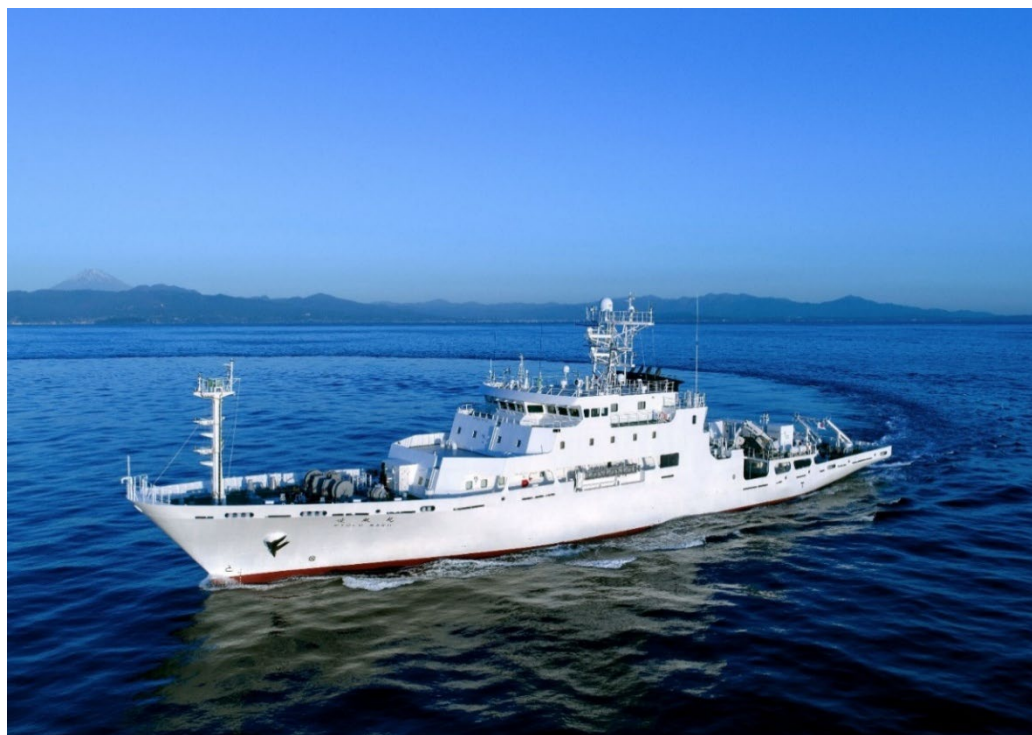
図 5-6-12 凌風丸（Ⅳ世） 令和6年建造。総トン数 1,986トン。 設計思想としては凌風丸（Ⅲ世）を概ね引継ぎ、CTDによる海洋観測や高層気象観測を効率的に実施できる。また、ディーゼル推進と電気推進を組み合わせた、タンデムハイブリッド推進方式を採用し、燃費や運動性能の向上を図っている。
