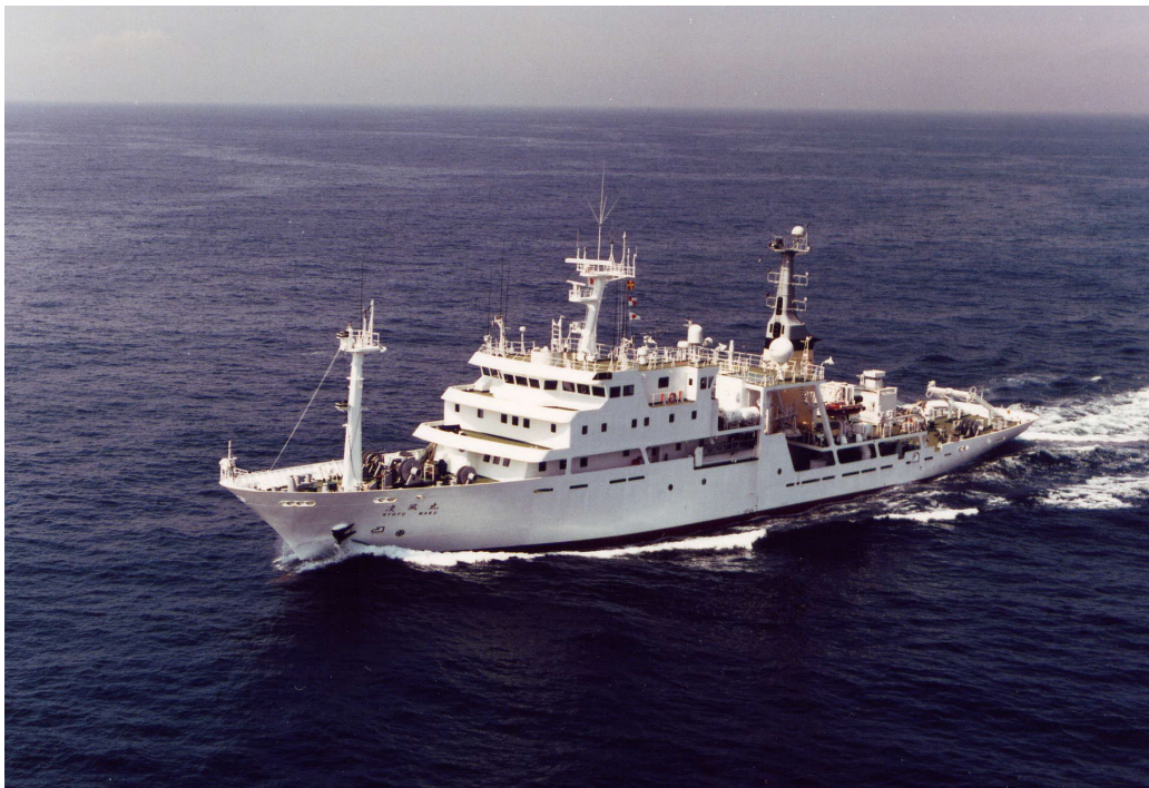
図 5-6-11 凌風丸（Ⅲ世） 平成7年建造。総トン数 1,380トン。 設計段階からCTDによる海洋観測を主として行う観測船としてまとめられた。観測時等における運動性能を向上させるため、特殊な舵（左右に並んだ2枚の舵を制御して、推進力を様々な方向に自在に向けられる機構）を装備している。また、建造時から高層気象観測用の放球コンテナ等の設備を搭載している。
