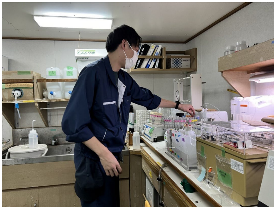
図 5-6-31 船内の観測室における海水試料分析 観測員が、各深度の分析用試水を自動化学分析装置（オートアナライザー）にセットして、栄養塩（ケイ酸塩、硝酸塩、亜硝酸塩、リン酸塩）の分析に取りかかろうとしているところ。
