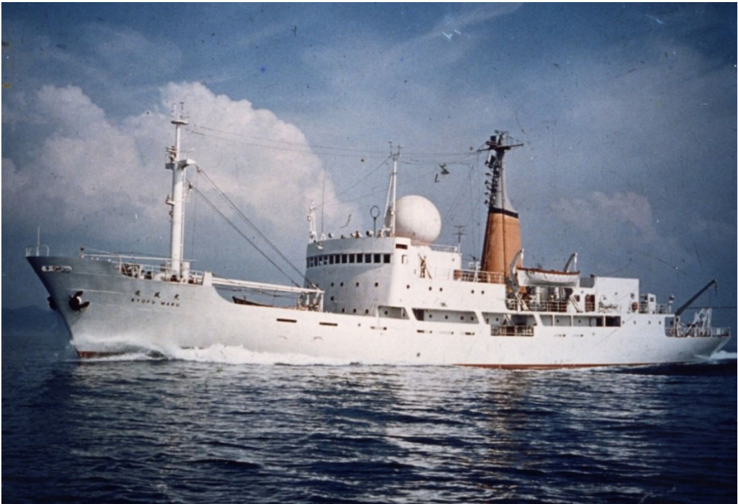
図 5-6-10 凌風丸（Ⅱ世） 昭和41年建造。総トン数 1,599トン。 気象庁の観測船として初めて気象レーダーを備えた。また、凌風丸（Ⅰ世）と同じく離島の観測所への補給機能を有しており、前甲板には荷役用の設備がある。CTD（電気伝導度水温水深計）が導入されると、それを用いた海洋観測が可能となるよう改装された。
