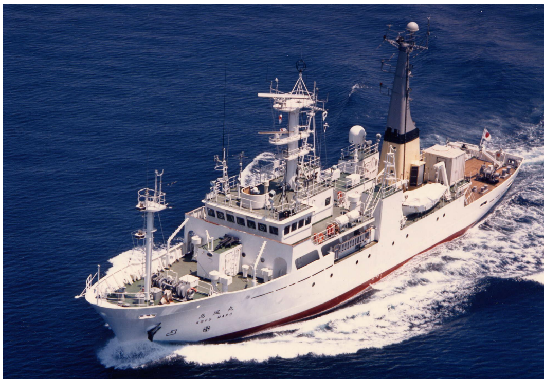
図 5-6-16 高風丸（Ⅱ世） 昭和63年建造。総トン数 487トン。函館海洋気象台所属。 図 5-6-23に示した長風丸（Ⅱ世）の次に建造された同船の姉妹船。新しい世代の中型観測船として、当初からCTD観測や高層気象観測などが効率よく実施できるよう設計・建造された。
