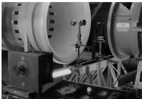
図 5-5-21 風洞測定部と制御関係機器
