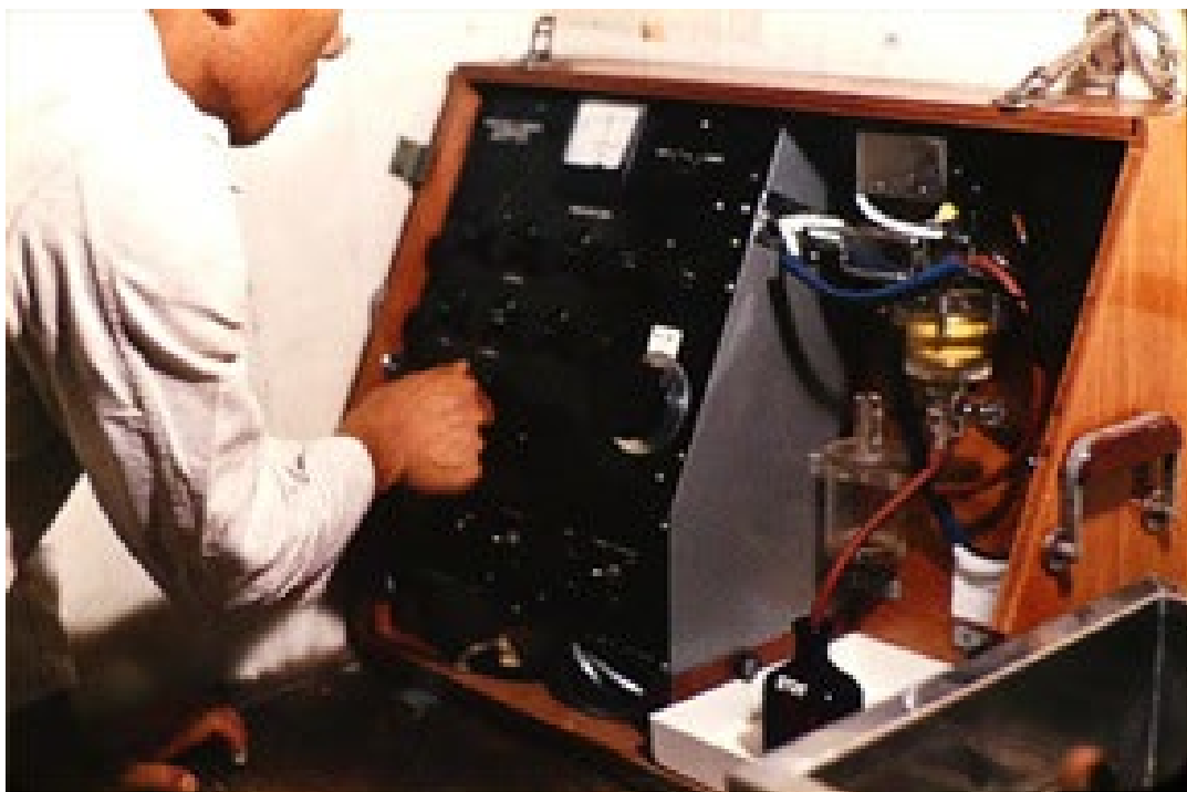
図 5-6-27 船内の観測室における塩分検定作業（1964年頃） 塩分計（サリノメーター）を用いて、ナンセン式採水器から得られた試水中の塩分を測定している。それぞれの試水の電気伝導度を測定することによって、塩分を求めている。
