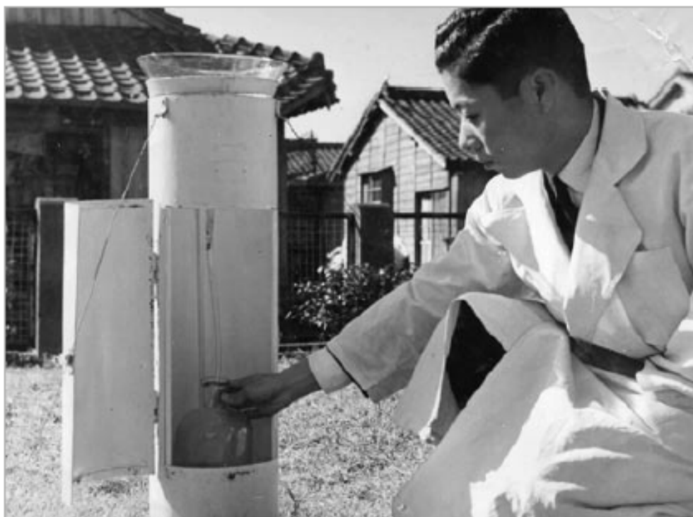
図 5-7-6 54A型採取装置（鹿児島地方気象台）での試料採取の様子
