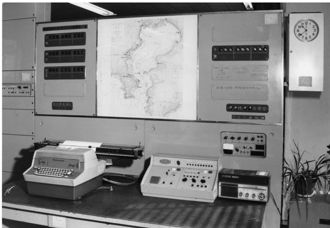
図 5-6-2 東京湾コールシステム（自動応答遠隔自記検潮装置）（1962年、気象庁本庁） 1959年伊勢湾台風災害を契機に高潮監視体制の強化。高潮被害が想定される東京湾、伊勢湾、大阪湾それぞれに整備。湾内にある複数の観測地点の潮位データを無線で受信し高潮の監視に活用。
