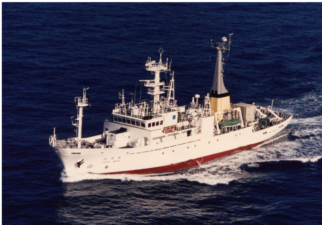
図 5-6-18 清風丸（Ⅲ世） 平成5年建造。総トン数 484トン。舞鶴海洋気象台所属。 図 5-6-23に示した長風丸（Ⅱ世）、図 5-6-16に示した高風丸（Ⅱ世）に次いで建造された両船の姉妹船。新しい世代の中型観測船として、当初からCTD観測や高層気象観測などが効率よく実施できるよう設計・建造された。
