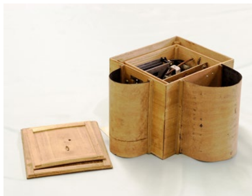
図 5-5-46 中央气象台1号型 ラジオゾンデ
