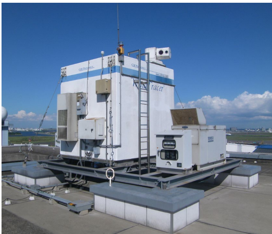
図 3-2-27 第一世代LIDAR：平成19年度から順次運用開始（羽田空港1号機）
