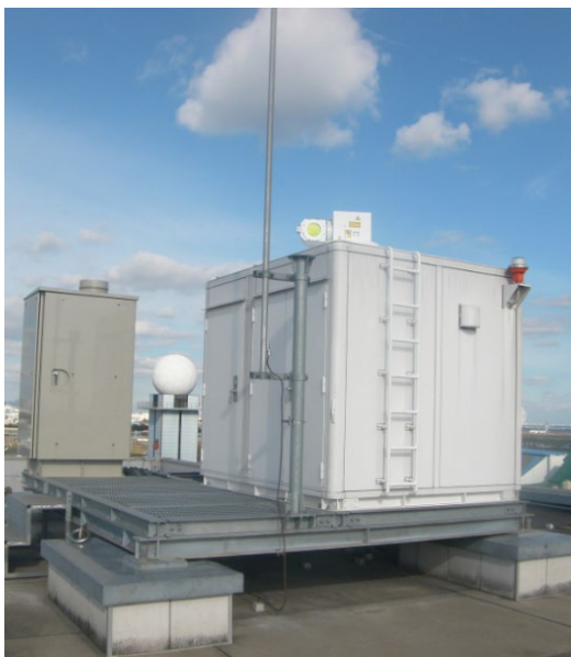
図 3-2-29 第二世代LIDAR 平成27年度から順次運用開始 （羽田空港1号機）
