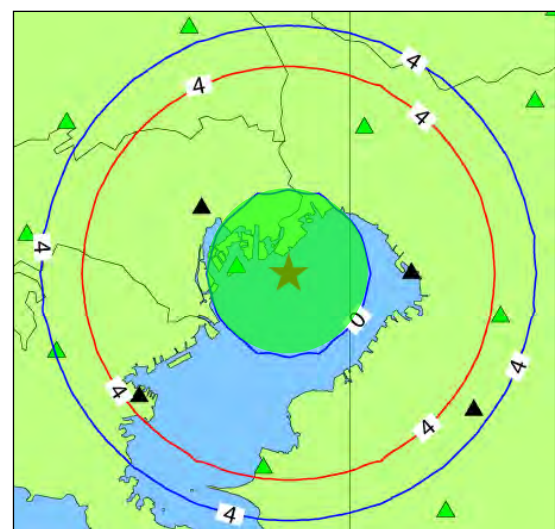
図 4-15 東京湾北部の想定地震(震央★、深さ 30km)発生時に想定される緊急地震速報(警報)発表から強い揺れの到達までの猶予時間(秒)
