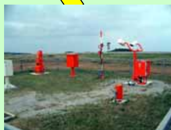
気象観測露場 温度・湿度計、シーロメータ、雨量計、視程計等
