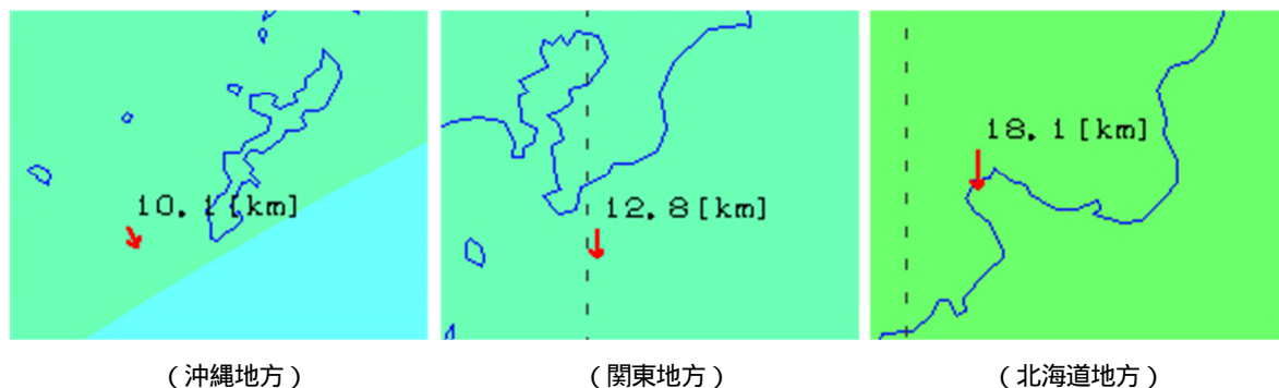
第 3.5.14 図 視差の大きさ (雲頂高度 15\text{km} の場合) と方向の代表例
