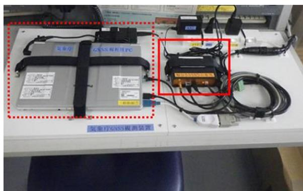
第 2.3 図 貨物船「琉球エクスプレス 3」操舵室に設置された GNSS 受信機（赤実線）及び解析 PC（赤破線）.
