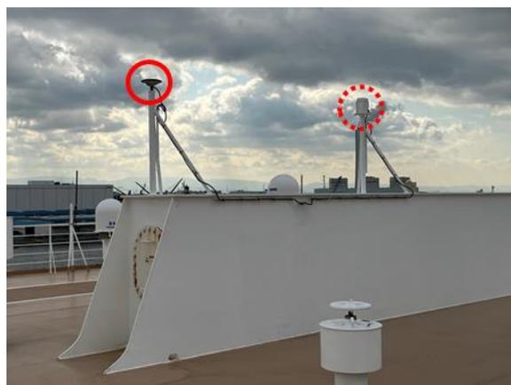
第 2.2 図 GNSS アンテナ（赤実線）及び送信機器（赤破線）の設置例. (a) 貨物船「あやはし」マスト, (b) フェリー「さんふらわあ きりしま」オンデッキガーダー.
