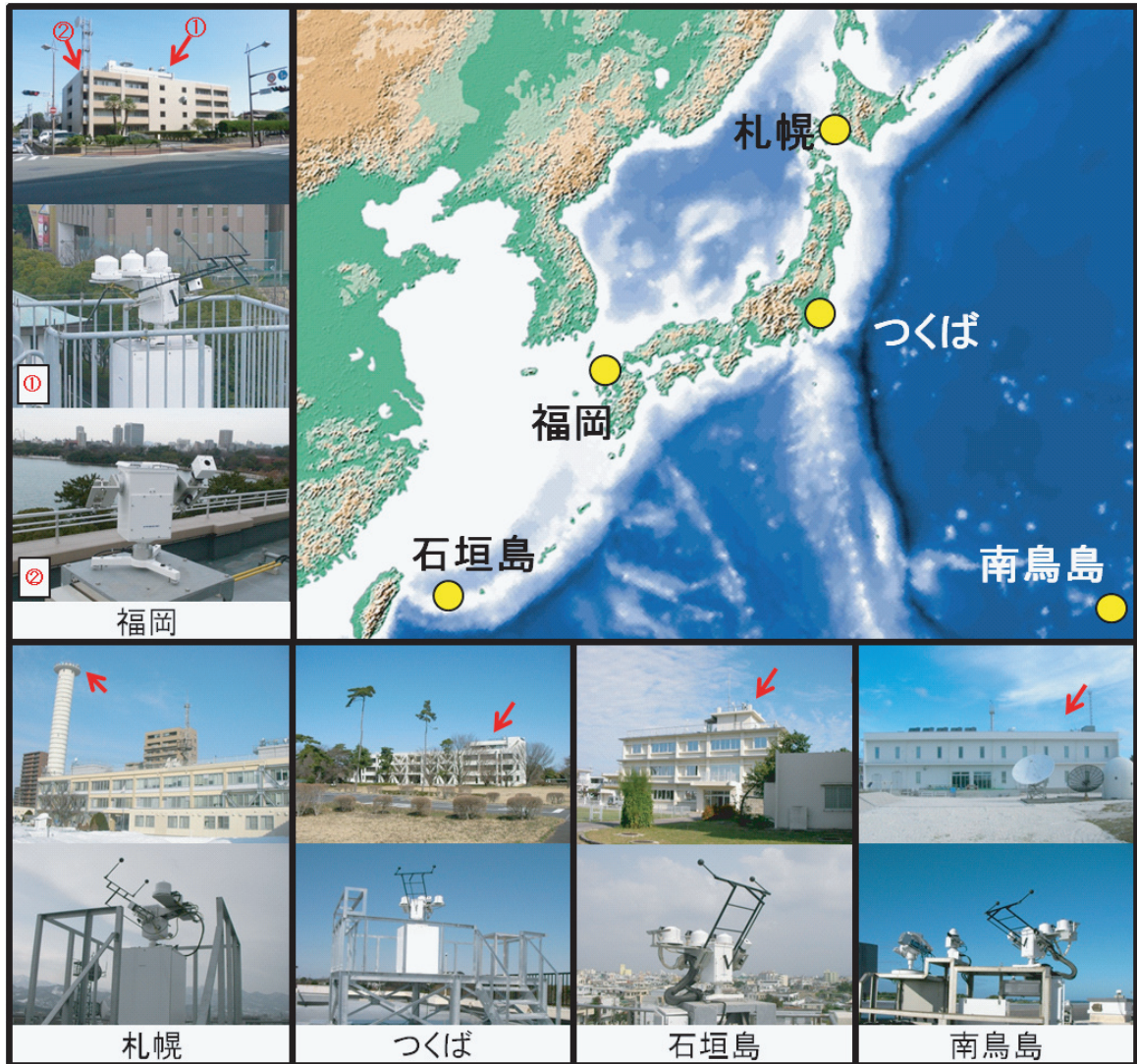
第 3.2 図 国内における日射放射観測網 赤矢印は、精密日射放射観測装置の設置場所を示す。
