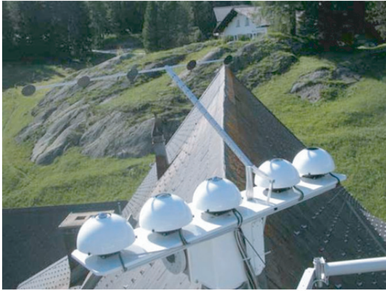
付図 2.7 赤外放射計の世界準器群 (WSG)
