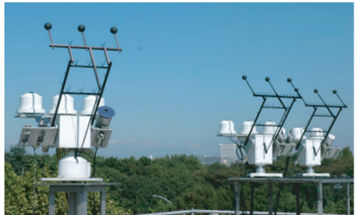
付図 2.11 屋外における赤外放射計比較較正
