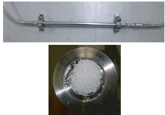
写真 4.3 除湿管（上）及び除湿管に過塩素酸マグネシウムを詰めた状態（下）
