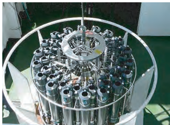
写真 2 CTD 投入前の 36 本掛け採水器
