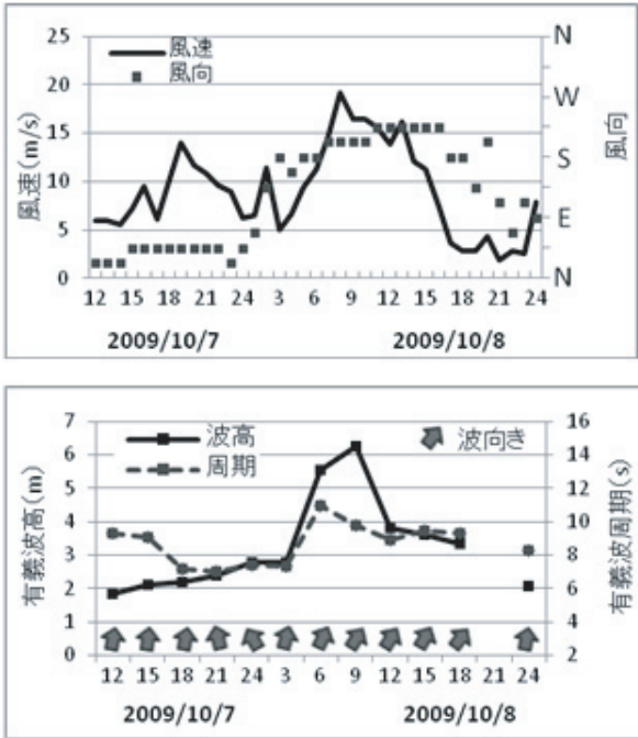
第51図 大島の風と波浪の観測値 (10月7日12時～8日24時) (上) 大島アメダスの観測値 (風速 (m/s) 及び風向) (下) 波浮港の観測値 (波高 (m), 周期 (s), 波向)
