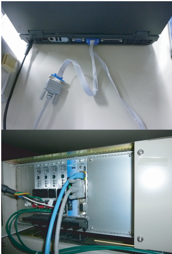
第 2 図 副振動監視システム（上）と検潮データ伝送装置（下）の接続例
