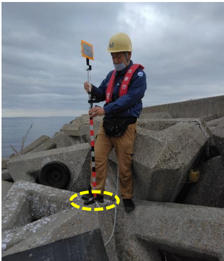
写真3-127 津波の痕跡 (図3-42 ⑦-1)
