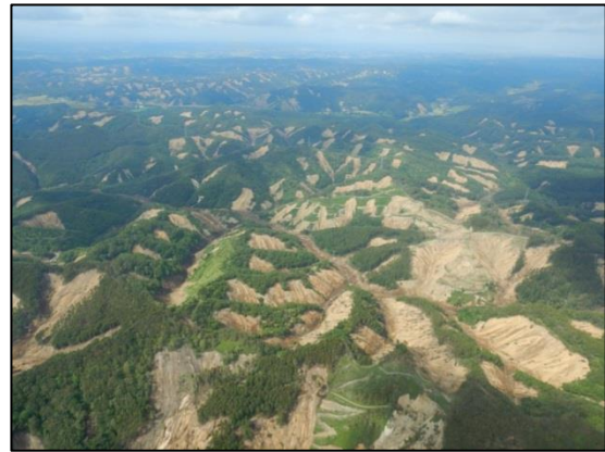
写真 31 斜面崩壊 (厚真町幌内) (北海道開発局提供)
