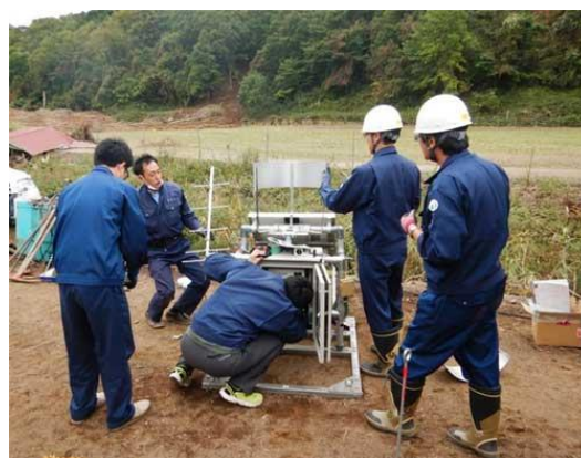
可搬型 DCP 雨量観測装置設置作業 (厚真幌内臨時雨量観測所)
