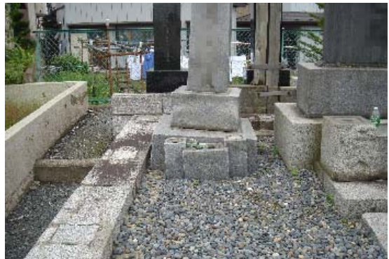
震度観測点の南東約25mにある墓地の状況。墓石が時計回りに5cm程ずれている。
