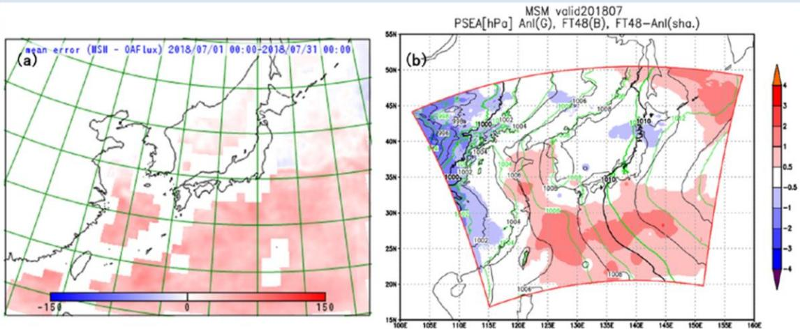
2018年7月平均における(a) MSMによる潜熱フラックス[W m<sup>-2</sup>]の全予報時間のOAFlexプロダクト(Yu et al. 2008)に対する誤差。(b) 海面更正気圧[hPa] (黒) FT=48のMSM、(緑)メソ解析、(カラー) FT=48のMSMのメソ解析に対する誤差。氏家(2020)から抜粋。
