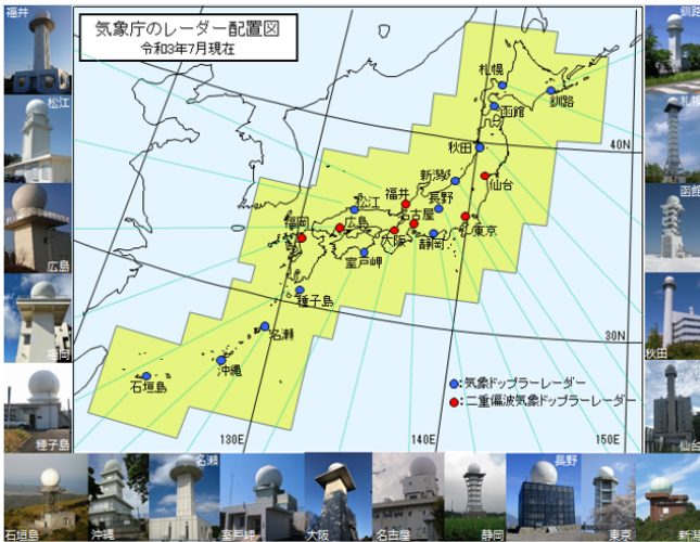
図 4.8.2 2021 年 7 月時点での気象庁一般気象レーダーの二重偏波レーダーへの更新状況。気象庁ホームページより。
