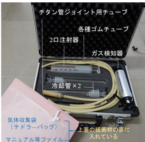
写真 12 火山ガス成分観測の機材収納例
