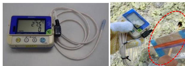
写真9 温度計 破線円：温度測定時に補助的に使用する差棒
