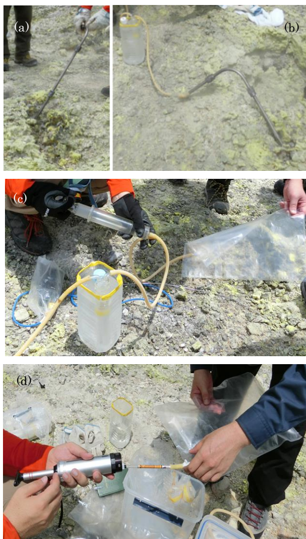
写真2 検知管法による火山ガス成分観測 (a) 噴気孔にチタン管を挿入する場面。 (b) 噴気孔から火山ガスを直接採取するためガス採取管とゴムチューブ、及び冷却管の接続例。 (c) 火山ガスを冷却し乾燥空気を抽出する場面。 (d) 検知管と採取器を使用した乾燥空気中の微量成分（ \text{CO}_2 や \text{H}_2\text{S} など）濃度の測定場面。
