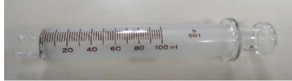
写真 4-a 吸引器 (二口ガラス吸引器) 100mL ピストン操作時に破損を防止するため、使用時には吸引器内部 (ピストン先端部) にはゴム管を短く切断した衝撃防止用ゴムを入れておく。
