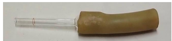
写真 6 ゴムチューブ (製品名 : アメゴム管) 太ゴム管加工例 (径変更用ガラス管 (写真 4-c) と繋げた状態)。
