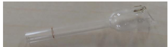
写真 4-c 径変更用ガラス管 既製品を加工利用 : Φ12 から Φ5 に変形
