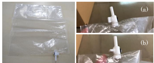
写真 5 ガス採取袋 (製品名 : テドラーバッグ) (a) コック開口時 (b) コック閉口時
