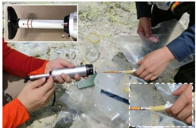
写真 20 検知管法による火山ガス濃度測定場面 ・測定に使用する各器具は直線状に配置する。 ・測定前は採取袋のコックを開く。測定終了後は速やかに閉じる。 ・採取器のレバー及び本体に付された赤印の位置を揃える (実線枠)。 ・吸引量 (50mL または 100mL) を確認後、採取器のレバーを一気に引いて規定時間待つ (破線枠)。
