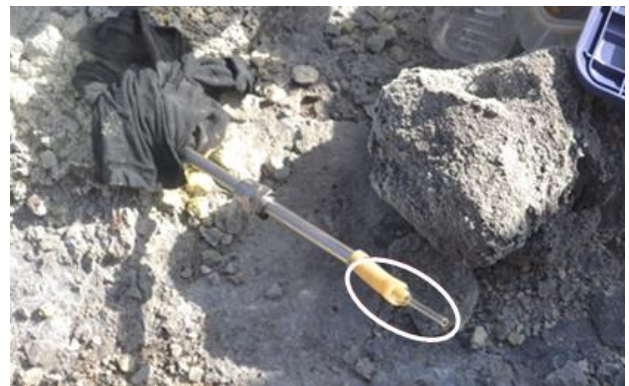
写真 14 噴気孔へのチタン管の設置
