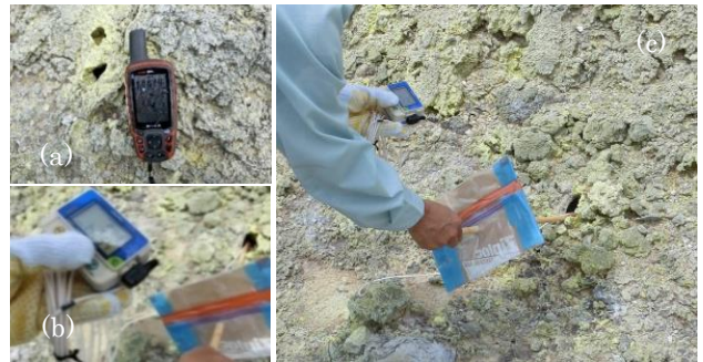
写真 13 噴気孔の位置及び温度の測定場面
