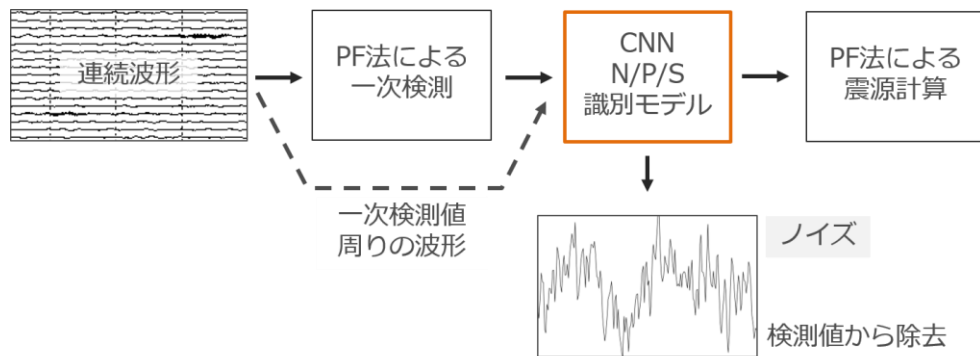
図 18 PF 法への，デノイザとしての N/P/S 識別モデルの適用イメージ。
