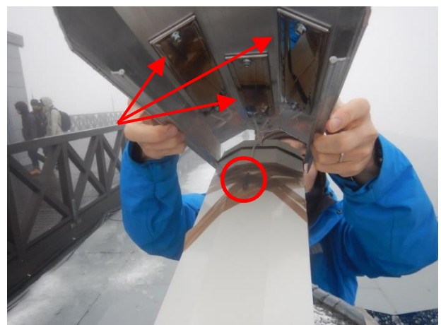
図 8：ハウジング③の天板内側について 200W×3 枚ヒーター（赤矢印）、ヒーター温度測定センサー（赤丸）。
