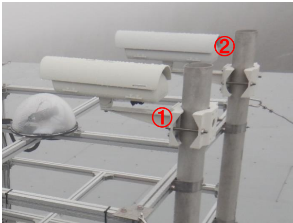
図 4：ダミーハウジング①、②。奥側のハウジングには着雪防止剤（フッ素樹脂塗料）を塗布、手前は無塗布。
