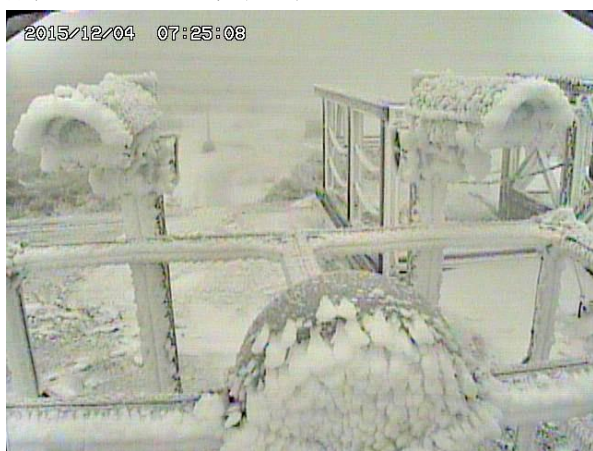
図 15：設置してから一晩経過したときの監視カメラ画像。左側のダミーハウジング②は着氷防止剤を塗布してあり、右側の同①は、着氷防止剤を無塗布。
