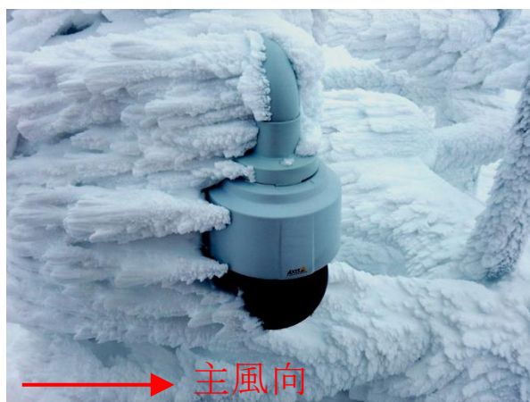
図 20：球形のハウジング④による着氷防止効果. 風上側に着氷はあるものの、風下側への着氷はほとんど見られない.
