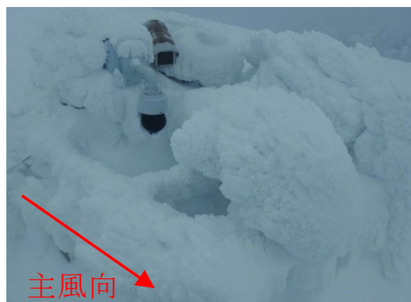
図 16：観測装置全体が樹氷化しているが、天板にヒーターが付いたハウジング③は樹氷化していない（2016/01/08 撮影）。
