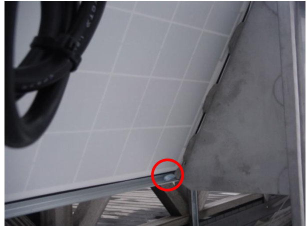
図 10：太陽光パネルの裏に取り付けた外気温測定センサー（赤丸）。2016/1/29 以降は、センサー位置を移動。
