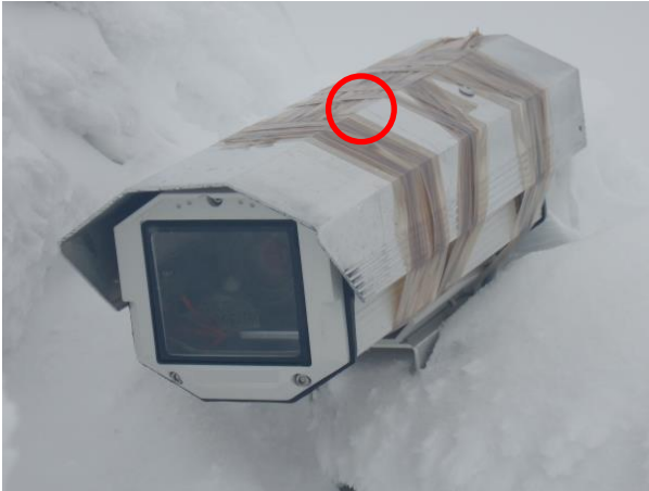
図 9：ハウジング③の表面温度測定センサー及びヒーター出力調整センサーの設置位置（赤丸）。ヒーター調整機は 200W×3 枚の出力 OFF/ON を調整する。ハウジング内部の 120W ヒーターも OFF/ON 切り替え可能で、内部温度により作動する。
