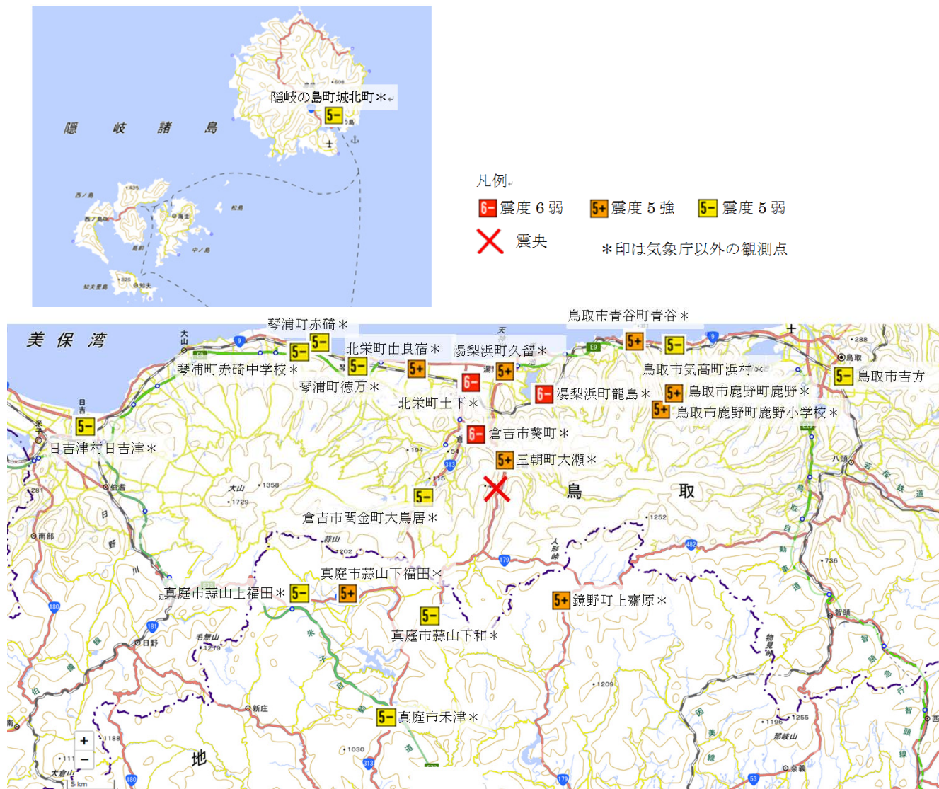
図 1 調査票の配付対象の震度観測点. 数字は震度観測点で観測された震度 (5- : 震度 5 弱, 5+ : 震度 5 強, 6- : 震度 6 弱. *印は気象庁以外の観測点) 国土地理院の電子地形図 (タイル) に震度観測点名と観測された震度を追記して掲載
