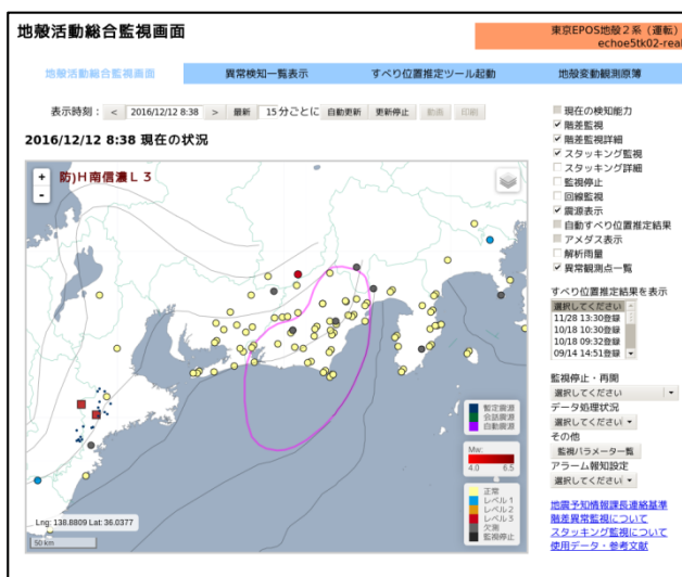
図 14 EPOS5 の地殻活動総合監視画面。画面は監視プログラムが出力した GeoJSON ファイルを JavaScript ライブラリで描画して構成している。
