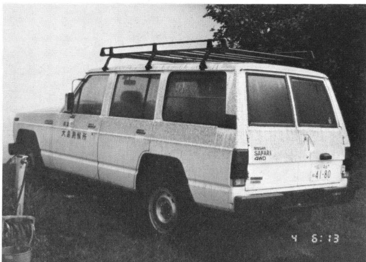
写真15 測候所構内の官用車に付着した火山灰
