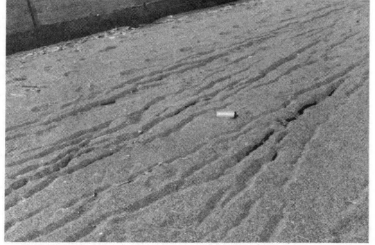
写真 6.3.16 三石町西浦里砂防堤付近の砂面にできた波状の地割れ
