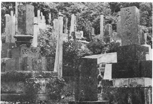
Photo. 3. 東伊豆町片瀬（龍淵院）の墓石の回転 （右回り）前面南西側から撮影
