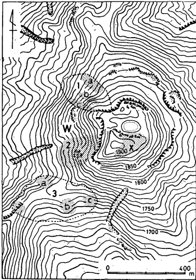
Fig. 10. 那須岳の地熱地帯。(1965年ごろの状態)(火山報告1965年による)。1, 2, 3の点線がかこんだ領域は、それぞれ第1, 第2, 第3噴気地帯と呼ばれている。黒く塗った地域は噴気活動の盛んな所。
