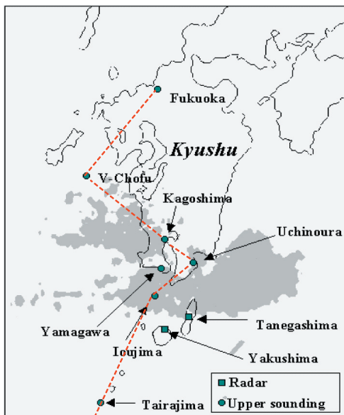
第 27 図 “九州豪雨観測実験”の高層観測とレーダーの観測点の配置図。影域は 1996 年 7 月 7 日 9 時の降水域を示す。図 29 の南北鉛直断面図は赤い点線に沿う観測点と名瀬測候所のデータから作成した。
