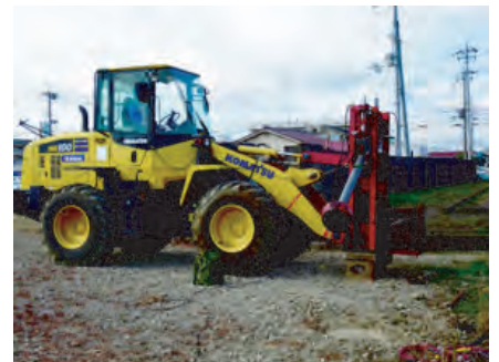
人工的に地面を揺らして、地下の構造を調査（和歌山県）
