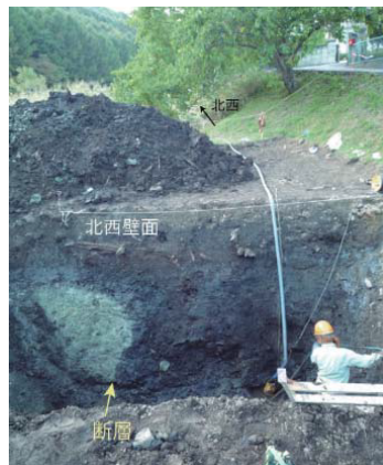
糸魚川－静岡構造線断層帯（中南部区間）にある釜無山断層群トレンチ調査において露出した断層（左：長野県茅野市）および変形した地層（右：長野県諏訪郡富士見町）
