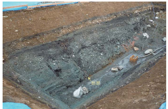
糸魚川－静岡構造線断層帯（中南部区間）にある釜無山断層群トレンチ調査において露出した断層（左：長野県茅野市）および変形した地層（右：長野県諏訪郡富士見町）
