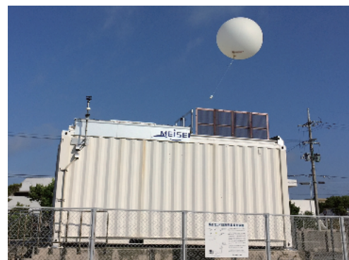
人によるラジオゾンデ飛揚(左)と機械による自動ラジオゾンデ飛揚(右)
