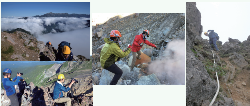
左上：遠い道のりを観測地点まで機材を背負って登山 左下：切立った崖の上から火口内を観測(可視及び熱映像観測) 中央：噴気地帯でのガス及び温度観測 右：急峻な岩場を登り目的地を目指します
