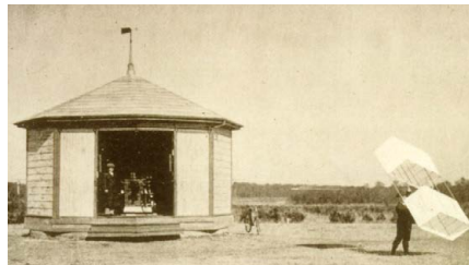
上空の気圧・気温・湿度を、記録紙に自動で記録できる気象測器を凧に取り付け、観測を行った。
