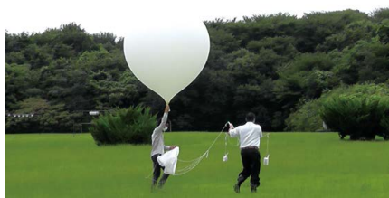
新旧ラジオゾンデを連結し1つの気球で飛揚する、比較観測の様子。比較観測により、気候変動監視に必要な新旧ゾンデの器差を得ることができる。
