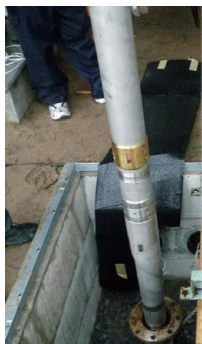
傾斜計（観測孔に埋設）
