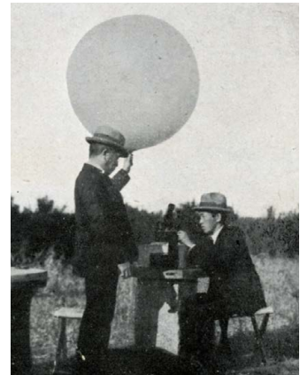
上空の風を探るため、放球した気球の動きを地上から「経緯儀」と呼ばれる望遠鏡で追跡した。
