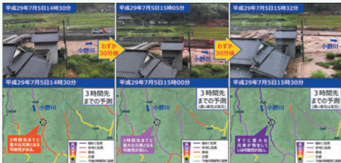
大分県日田市小野川の状況(上段)と「洪水警報の危険度分布」(下段)。黒丸は写真を撮影した場所。わずか1時間のうちに「洪水警報の危険度分布」で急激に危険度が高まっており、実際の水位も急激に上昇して氾濫しています。(写真:日田市職員提供)
