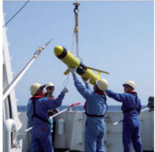
観測船凌風丸からクレーンで水中グライダーを海面に下します。水中グライダーによる海洋観測がいよいよ始まります。
