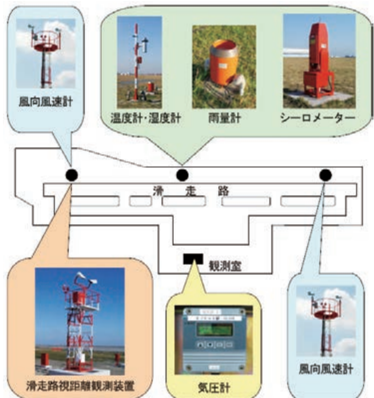
空港に整備する気象観測測器の配置例
