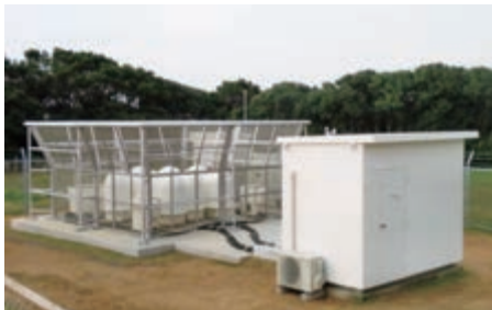
ウィンドプロファイラ観測局（清水）の全景。フェンス内に11個のアンテナが設置されています。
