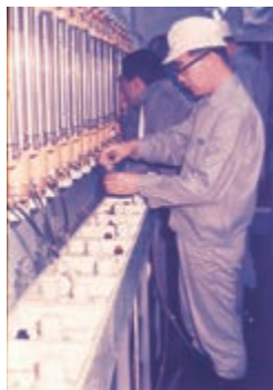
（左） 手前ではナンセン採水器から採水し、奥では転倒温度計の値を読み取っている （右） 投入前の電気伝導度水深計・多筒採水器システム
