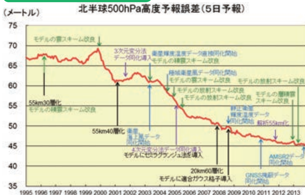
全球モデルにおける新たな技術の導入と予報精度の変遷。縦軸は、全球モデルの予報精度の指標となる北半球の 500 ヘクトパスカル高度の 5 日予報の平方根平均二乗誤差 (単位: メートル) で、値が小さいほど予報精度が高いことを意味する。
