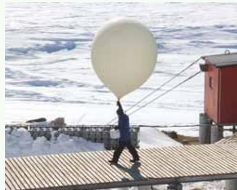
南極昭和基地でのオゾンゾンデを用いたオゾン観測の様子。上空約35キロメートルまでのオゾンの詳細な高度分布を直接観測しています(第52次南極地域観測隊員撮影)。
