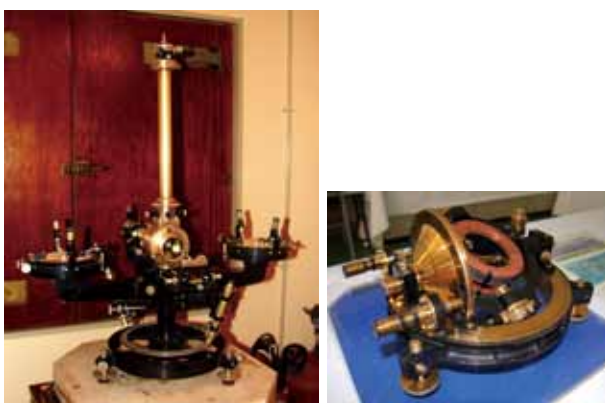
左:シュミット型磁気儀、右:アスカニヤ・シュミット型アースインダクタンス
