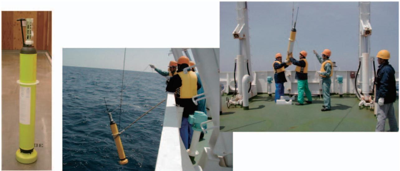
中層フロートは、海面から深さ 2000 メートル付近までの水温・塩分の鉛直分布を自動的に観測する機器です。WMO、IOC や各国の関係機関の連携により、中層フロートを全世界の海洋に常時約 3,000 台稼働させ、全世界の海洋の状況をリアルタイムで監視するとともに、地球温暖化をはじめとする気候変動の実況把握とその予測精度向上を目指す「アルゴ計画」が推進されており、気象庁は、文部科学省などの関係省庁と連携して中層フロートによる観測を実施しています。
