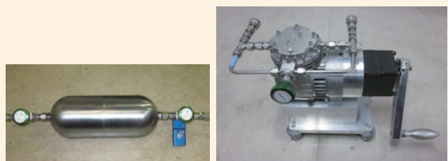
(上) 気象庁職員が航空機内において手動でポンプを回し、機外の大気を採取します。(下) 大気採取に使用する容器と手動ポンプ。
