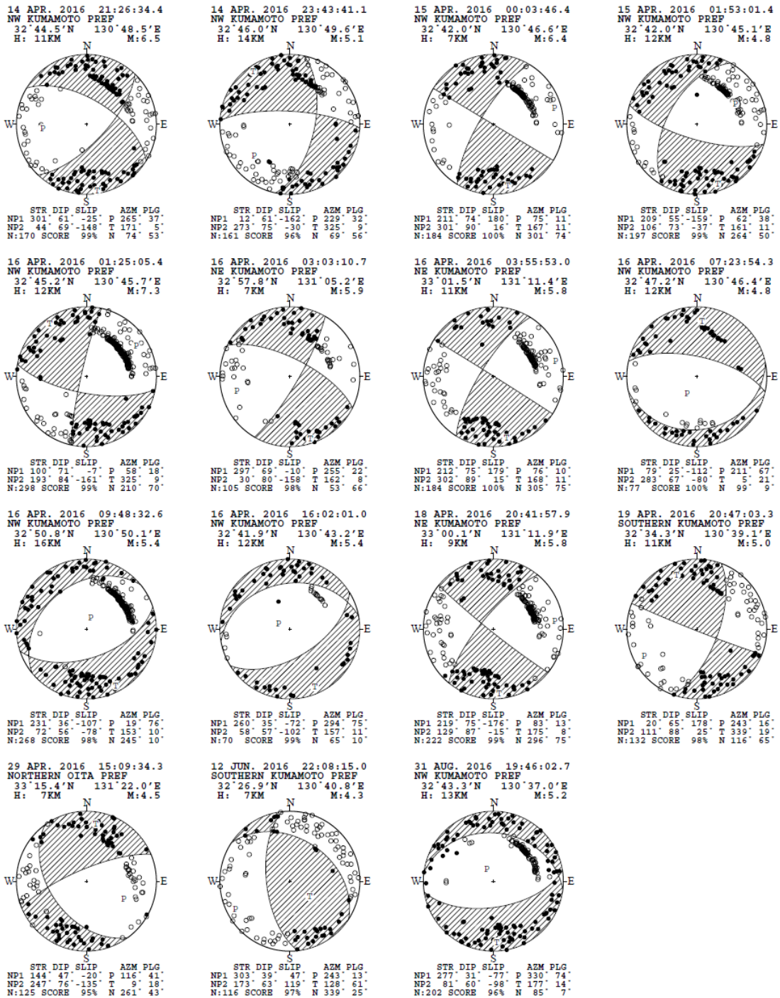
第3.3.2図 P波初動分布から決めた発震機構解(下半球投影)
