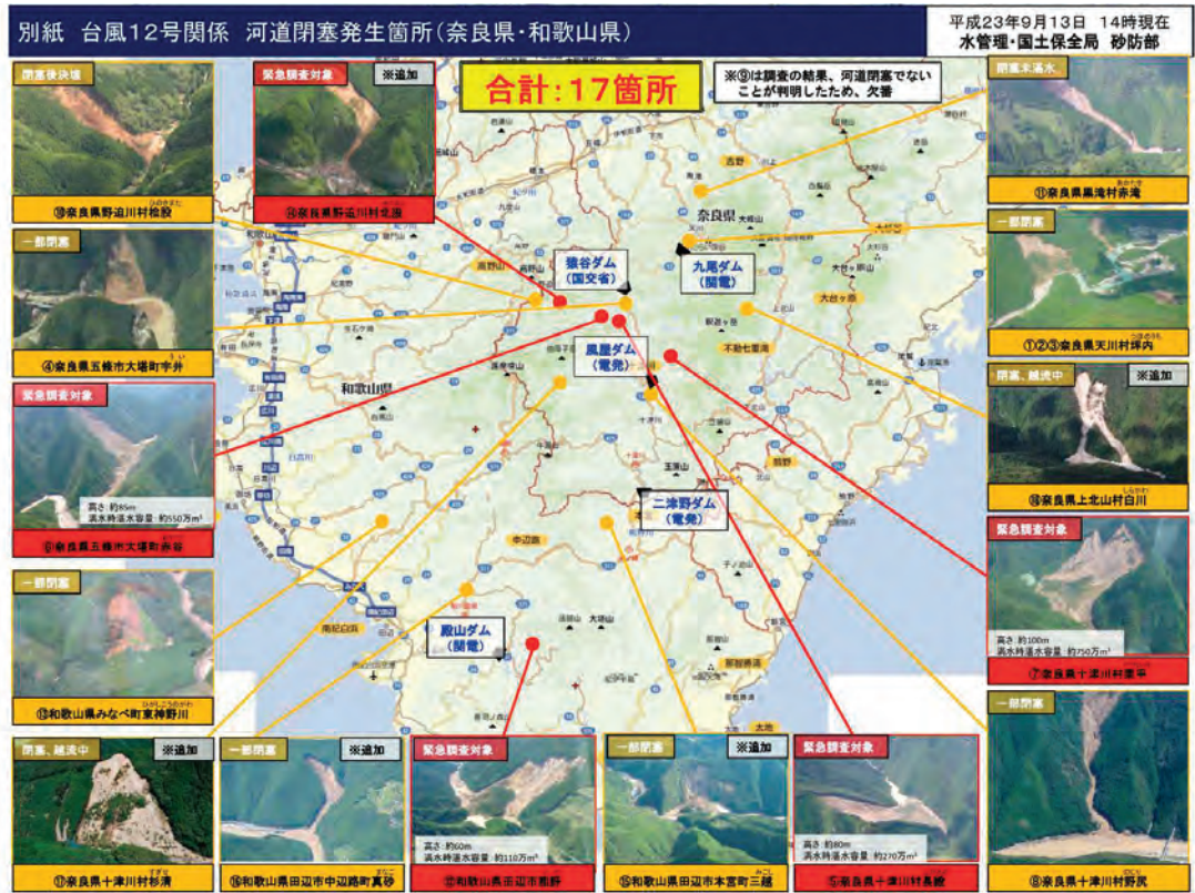
第 1.2.7 図 台風第 12 号の豪雨に伴う河道閉塞箇所 平成 23 年 9 月 13 日 国土交通省水管理・国土保全局砂防部報道発表資料より 赤枠：土砂災害防止法に基づく緊急調査対象箇所，黄枠：その他河道閉塞発生箇所
