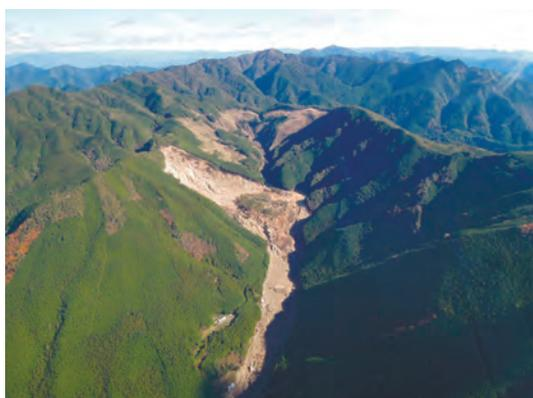
写真 2.2.3.4 田辺市熊野（いや）地区に発生した大規模な土砂崩れとそれによる河道閉塞
