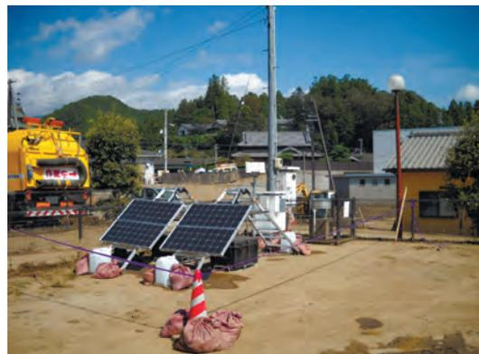
写真2.2.3.2 本宮地域雨量観測所に仮設置した可搬型観測装置
