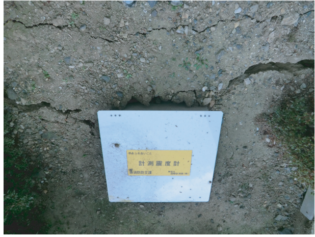
写真 45 常陸太田市金井町：欠測 震度計台の周りの地盤に亀裂が生じたため 活用停止
