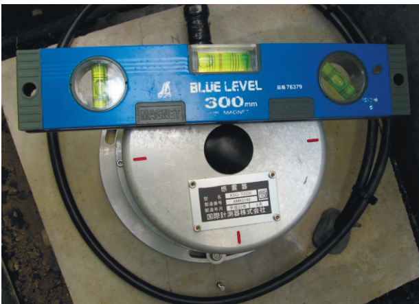
写真 70 常総市水海道諏訪町：5強 震度計台と地盤の間に隙間及び震度計台に傾きが認められたため活用停止。
