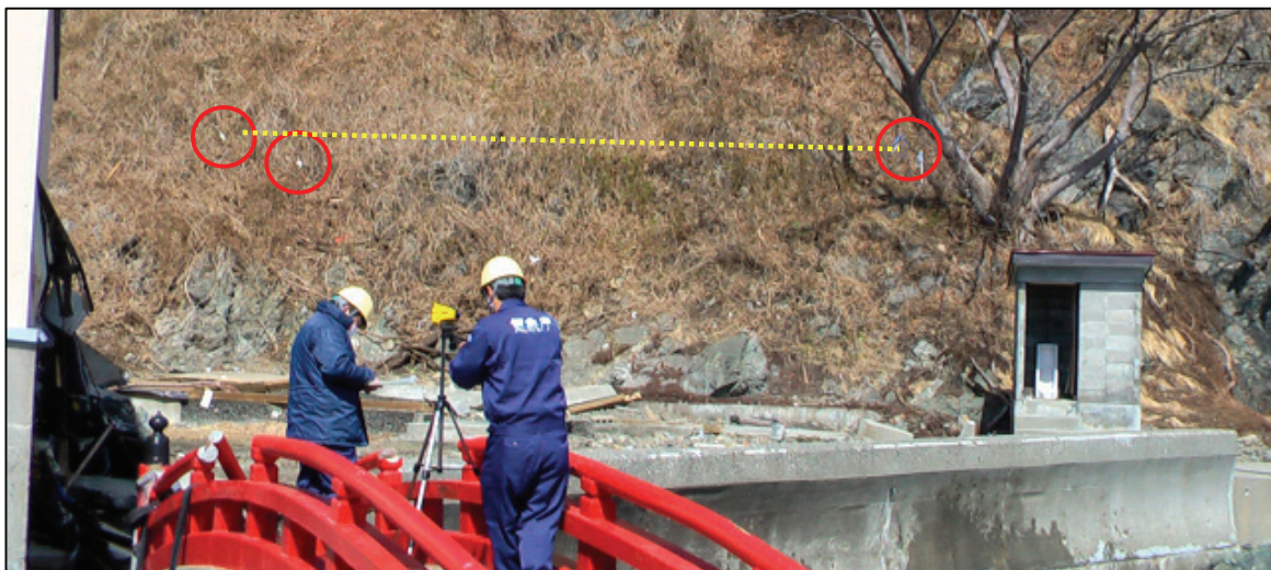
写真99 津波の痕跡（第3.2.83図の99）赤丸内で漂着物を確認
