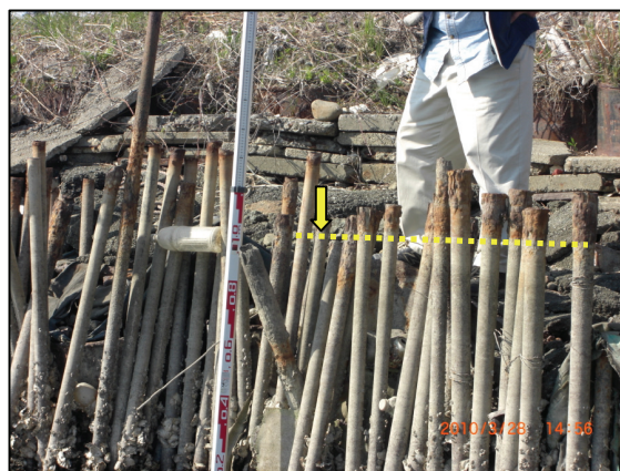
写真188 津波の痕跡 (第3.2.131図の191)
